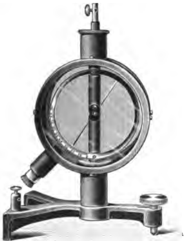
Abb. 30. Elektrometer nach Braun.
